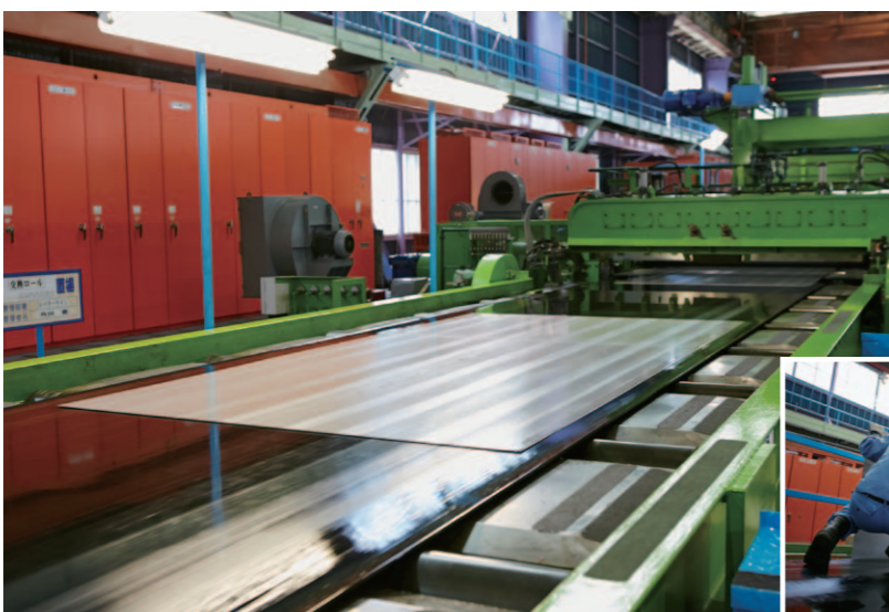
レベラーシャーラインによって鋼板を平坦にしながら顧客の要望に応じてさまざまなサイズにカット。ラインではスタッフの目と手によって鋼板を繰り返しチェックしていた。最新の設備と人間との共同作業によって古賀オールの品質が維持されるのだろう
