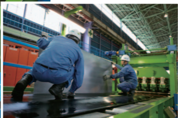
レベラーシャーラインによって鋼板を平坦にしながら顧客の要望に応じてさまざまなサイズにカット。ラインではスタッフの目と手によって鋼板を繰り返しチェックしていた。最新の設備と人間との共同作業によって古賀オールの品質が維持されるのだろう
